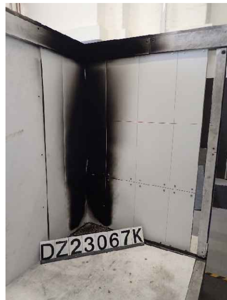
Foto 20: Prüfkörper DZ3.1/23-067K („K-300“), Ansicht nach der Prüfung.
