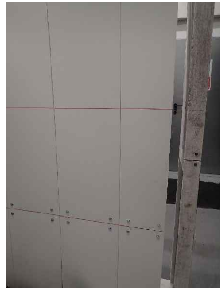
Foto 18: Prüfkörper DZ3.1/23-067K („K-300“), Detailansicht der Außenkante des breiten Probenflügels in Höhe von 500 mm in einem Winkel von ca. 45° vor der Brandprüfung.
