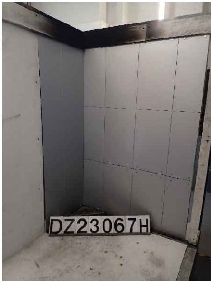
Foto 5: Prüfkörper DZ3.1/23-067H („K-300“), Ansicht des großen Flügels vor der Brandprüfung.
