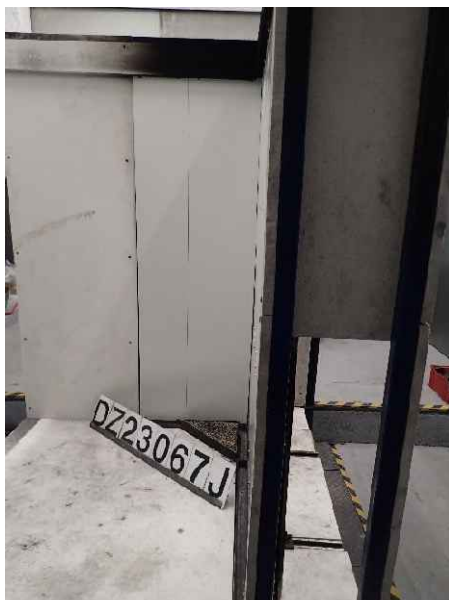
Foto 15: DZ3.1/23-067J („K-300“), Ansicht des Luftspalts des großen Flügels vor der Brandprüfung.
