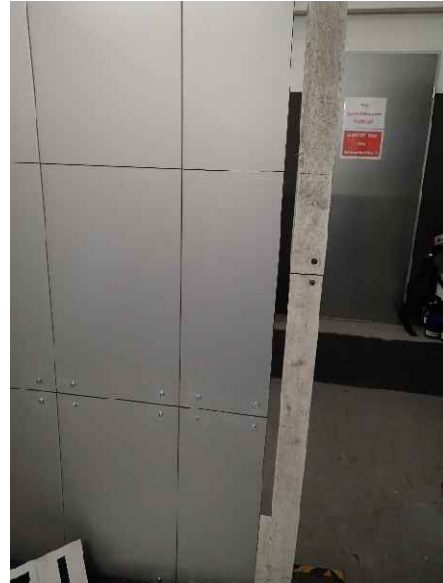
Foto 10: Prüfkörper DZ3.1/23-0671 („K-300“), Detailansicht der Außenkante des breiten Probenflügels in Höhe von 500 mm in einem Winkel von ca. 45° vor der Brandprüfung.
