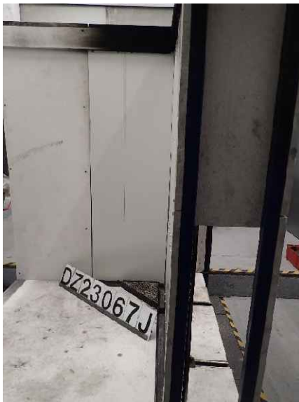
Foto 13: Prüfkörper DZ3.1/23-067J („K-300“), Ansicht des großen Flügels vor der Brandprüfung.
