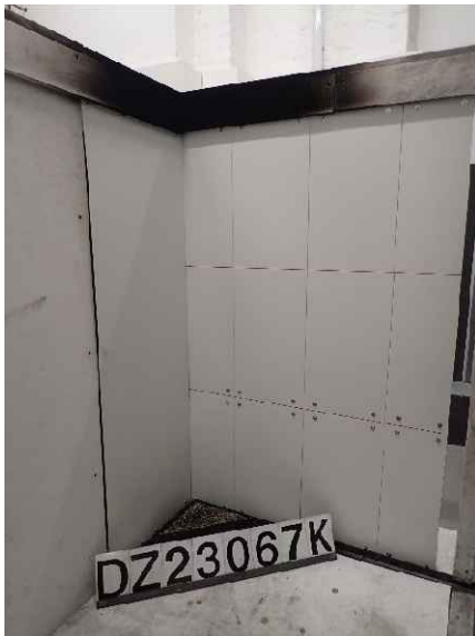
Foto 17: Prüfkörper DZ3.1/23-067K („K-300“), Ansicht des großen Flügels vor der Brandprüfung.
