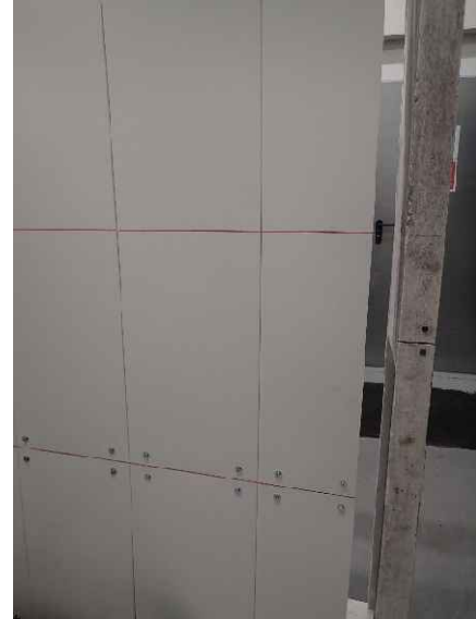
Foto 22: Prüfkörper DZ3.1/23-067L („K-300“), Detailansicht der Außenkante des breiten Probenflügels in Höhe von 500 mm in einem Winkel von ca. 45° vor der Brandprüfung.
