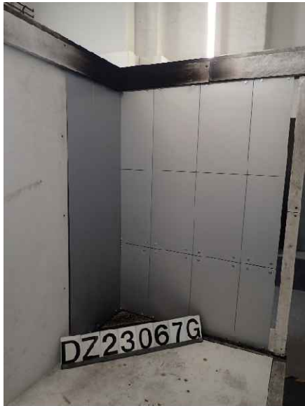
Foto 1: Prüfkörper DZ3.1/23-067G („K-300“), Ansicht des großen Flügels vor der Brandprüfung.
