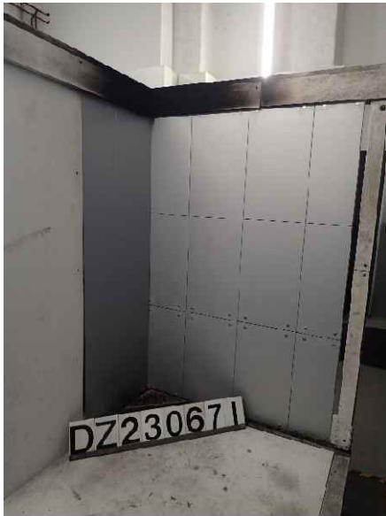
Foto 9: Prüfkörper DZ3.1/23-0671 („K-300“), Ansicht des großen Flügels vor der Brandprüfung.
