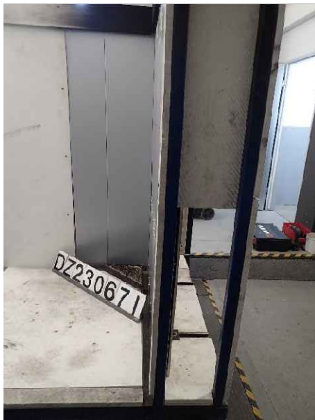
Foto 11: DZ3.1/23-0671 („K-300“), Ansicht des Luftspalts des großen Flügels vor der Brandprüfung.
