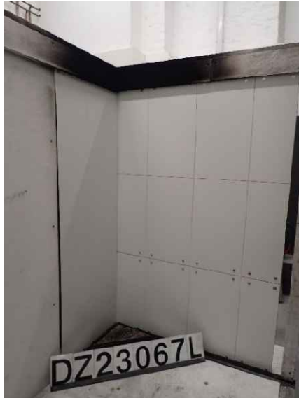
Foto 21: Prüfkörper DZ3.1/23-067L („K-300“), Ansicht des großen Flügels vor der Brandprüfung.
