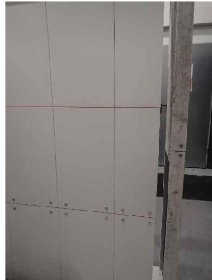
Foto 14: Prüfkörper DZ3.1/23-067J („K-300“), Detailansicht der Außenkante des breiten Probenflügels in Höhe von 500 mm in einem Winkel von ca. 45° vor der Brandprüfung.
