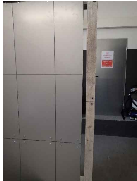
Foto 6: Prüfkörper DZ3.1/23-067H („K-300“), Detailansicht der Außenkante des breiten Probenflügels in Höhe von 500 mm in einem Winkel von ca. 45° vor der Brandprüfung.
