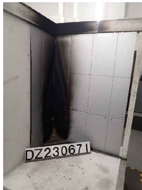
Foto 12: Prüfkörper DZ3.1/23-0671 („K-300“), Ansicht nach der Prüfung.
