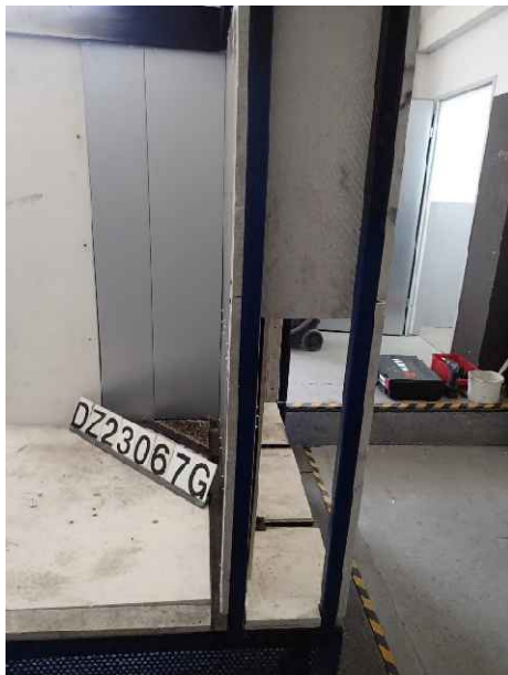
Foto 3: DZ3.1/23-067G („K-300“), Ansicht des Luftspalts des großen Flügels vor der Brandprüfung.
