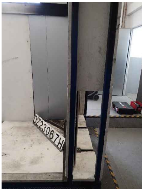
Foto 7: DZ3.1/23-067H („K-300“), Ansicht des Luftspalts des großen Flügels vor der Brandprüfung.
