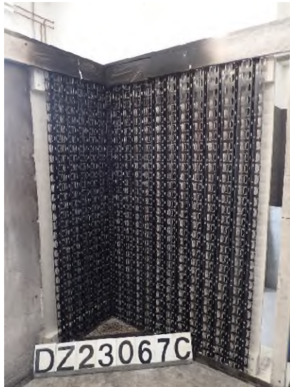
Foto 9: Prüfkörper DZ3.1/23-067C („Tragschienen universal aus Aluminium“), Ansicht des großen Flügels vor der Brandprüfung.
