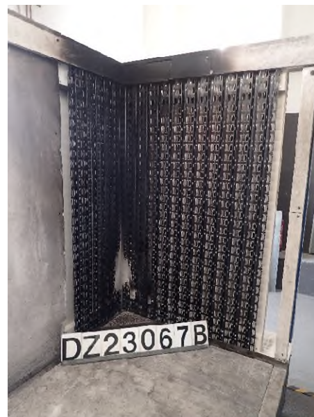
Foto 8: Prüfkörper DZ3.1/23-067B („Tragschienen universal aus Aluminium“), Ansicht nach der Prüfung.
