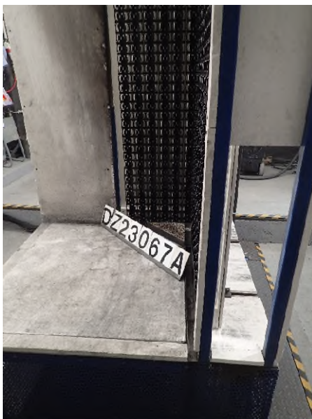
Foto 3: DZ3.1/23-067A („Tragschienen universal aus Aluminium“), Ansicht des Luftspalts des großen Flügels vor der Brandprüfung.
