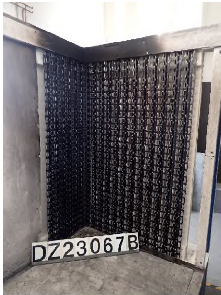
Foto 5: Prüfkörper DZ3.1/23-067B („Tragschienen universal aus Aluminium“), Ansicht des großen Flügels vor der Brandprüfung.
