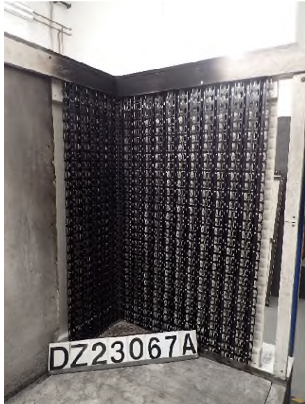
Foto 1: Prüfkörper DZ3.1/23-067A („Tragschienen universal aus Aluminium“), Ansicht des großen Flügels vor der Brandprüfung.
