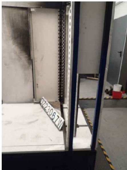
Foto 15: DZ3.1/23-067W („Tragschienen universal aus Aluminium“), Ansicht des Luftspalts des großen Flügels vor der Brandprüfung.
