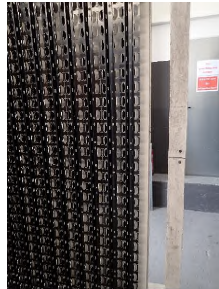
Foto 6: Prüfkörper DZ3.1/23-067B („Tragschienen universal aus Aluminium“), Detailsicht der Außenkante des breiten Probenflügels in Höhe von 500 mm in einem Winkel von ca. 45° vor der Brandprüfung.
