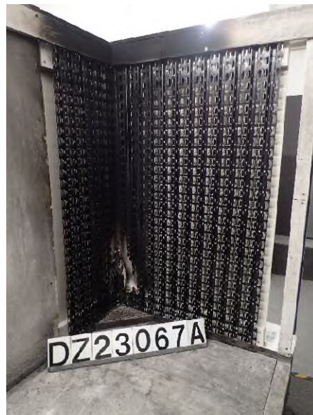
Foto 4: Prüfkörper DZ3.1/23-067A („Tragschienen universal aus Aluminium“), Ansicht nach der Prüfung.
