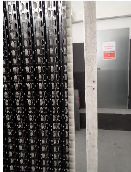
Foto 2: Prüfkörper DZ3.1/23-067A („Tragschienen universal aus Aluminium“), Detailansicht der Außenkante des breiten Probenflügels in Höhe von 500 mm in einem Winkel von ca. 45° vor der Brandprüfung.
