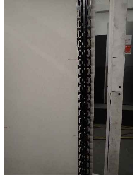
Foto 14: Prüfkörper DZ3.1/23-067W („Tragschienen universal aus Aluminium“), Detailansicht der Außenkante des breiten Probenflügels in Höhe von 500 mm in einem Winkel von ca. 45° vor der Brandprüfung.
