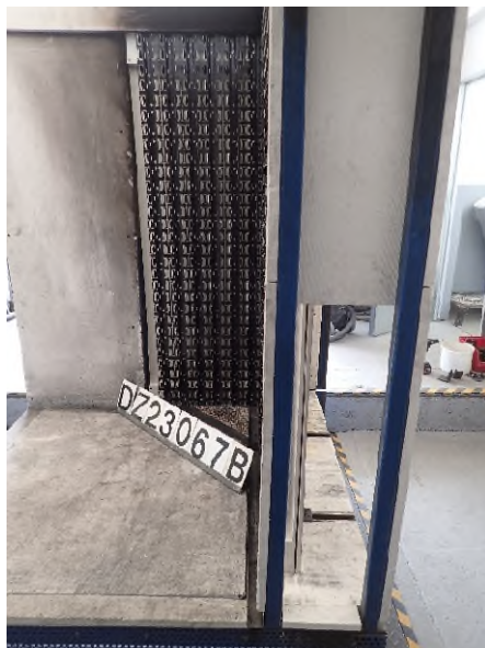
Foto 7: DZ3.1/23-067B („Tragschienen universal aus Aluminium“), Ansicht des Luftspalts des großen Flügels vor der Brandprüfung.
