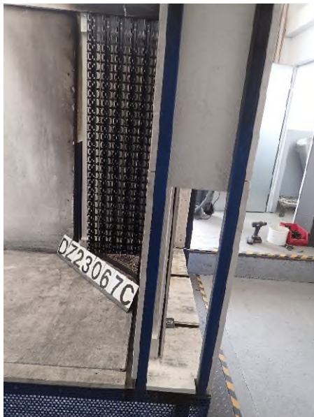
Foto 11: DZ3.1/23-067C („Tragschienen universal aus Aluminium“), Ansicht des Luftspalts des großen Flügels vor der Brandprüfung.
