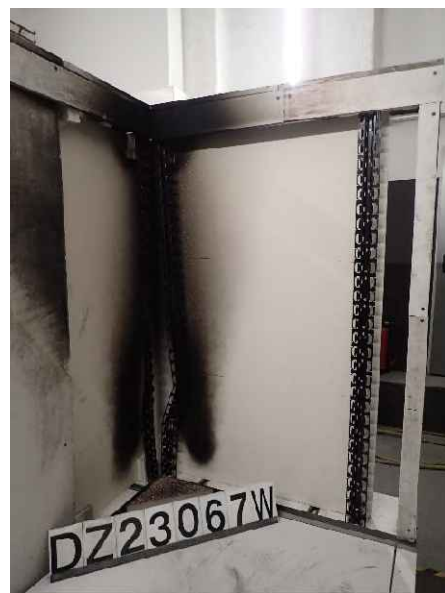
Foto 16: Prüfkörper DZ3.1/23-067W („Tragschienen universal aus Aluminium“), Ansicht nach der Prüfung.
