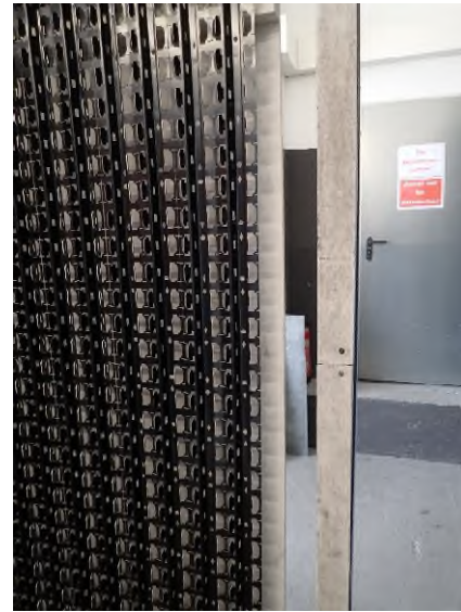
Foto 10: Prüfkörper DZ3.1/23-067C („Tragschienen universal aus Aluminium“), Detailsicht der Außenkante des breiten Probenflügels in Höhe von 500 mm in einem Winkel von ca. 45° vor der Brandprüfung.
