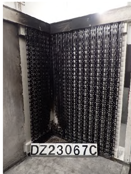
Foto 12: Prüfkörper DZ3.1/23-067C („Tragschienen universal aus Aluminium“), Ansicht nach der Prüfung.
